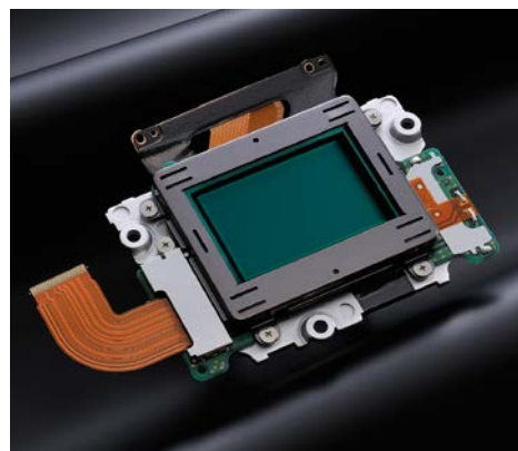
Abb. 1.16: CMOS-Vollformatsensor der D610 © Nikon GmbH 2013
